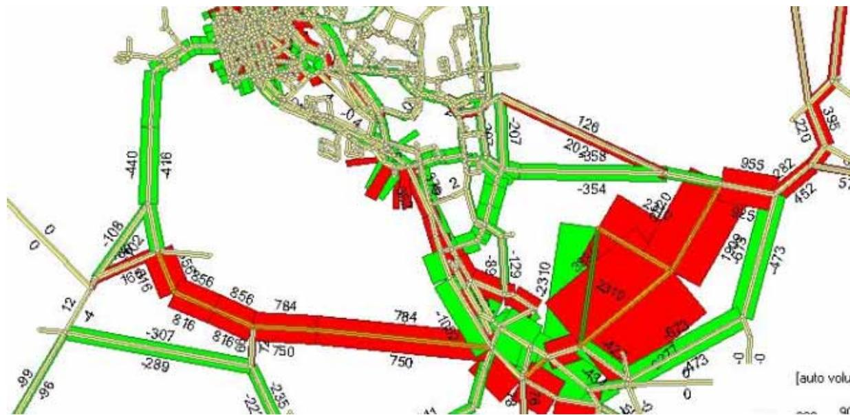
Kuva 39. Fladan-vaihtoehdon liikennemääät vuonna 2030. Bild 39. Trafikmängder i Fladan-alternativet 2030.
